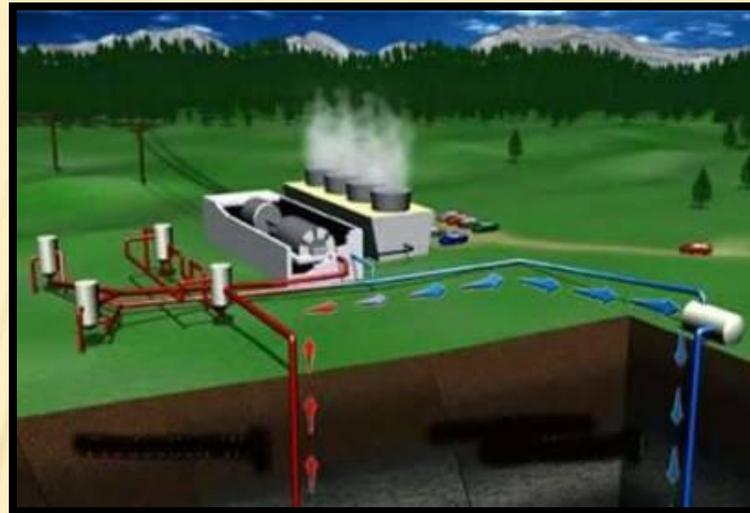
Figura: Esquema de uma central geotérmica
